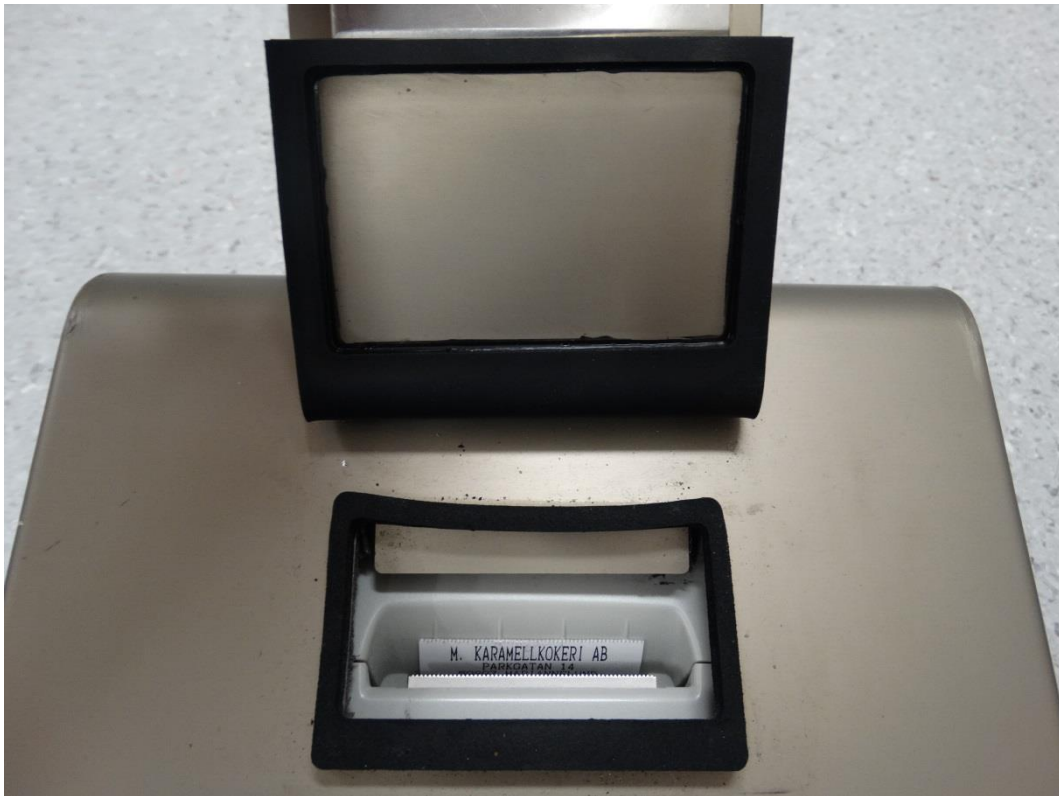
Bild 3: Kvittoluckan hos väderkåpan i öppen position (som vid normal användning)
